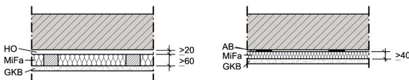
**Bild 7-2** Geeignete biegeweiche Vorsatzschalen für die Verbesserung einschaliger biegesteifer Wände (Auszug aus DIN 4109 Beiblatt 1) HO Hohlraum, MiFa mineralischer Faserdämmstoff, GKB Gipskarton-Bauplatte, AB Ansatzbinder (punkt- oder streifenförmig)
