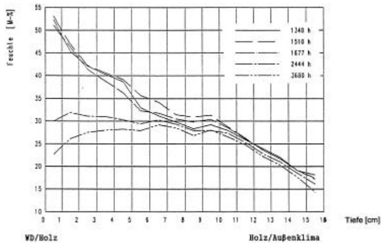
Bild 9 Feuchteverlauf im Holz/Eiche über den Querschnitt während der Sommerperiode
