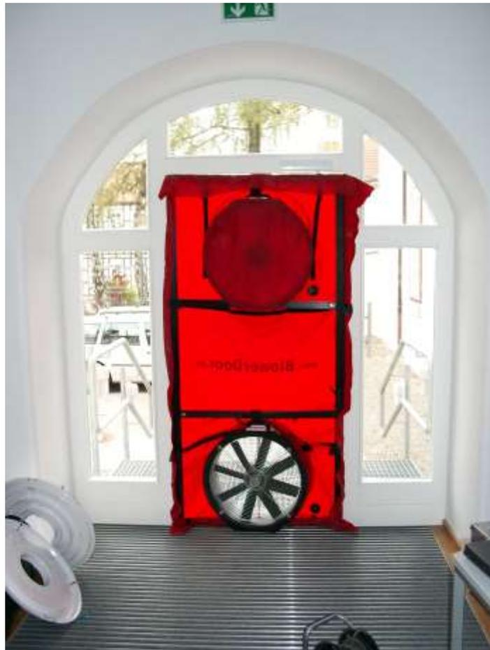
**Abbildung 3-1 Aufbau einer BlowerDoor Messung**
